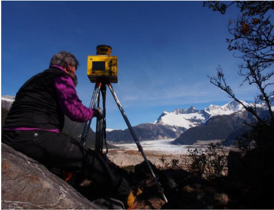
Misure laser scanner della fronte del ghiacciaio
